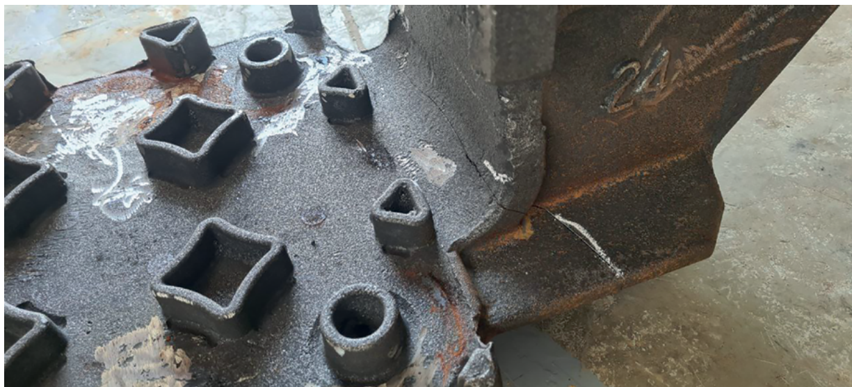
Рис. 4. Характер и зона усталостного разрушения боковой рамы 20164 тележки модели 18-9891 (черт. № 9891.01.00.001) (автор фото — С. О. Комиченко)
